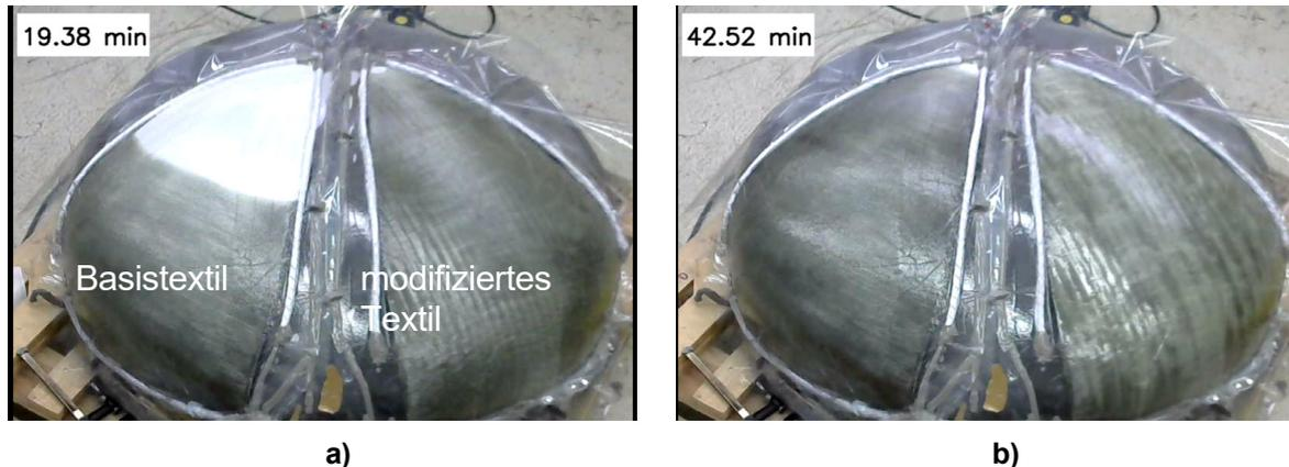
**Abbildung 49: Vergleich der Infiltrationszeit beim Demonstrator 1 Klörperboden: a) Momentaufnahme der vollständigen Infiltration vom modifizierten Textil, b) Momentaufnahme der vollständigen Infiltration vom Basistextil**
