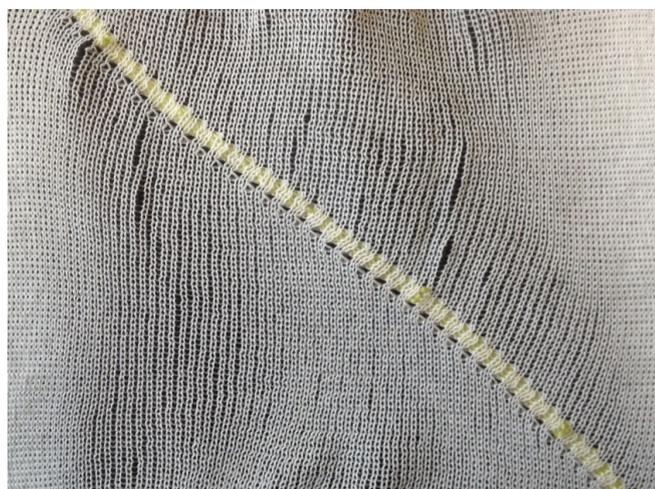
**Abbildung 29: Frei orientiert eingebrachter Fließkanal, Verzicht auf Kett- und Schussfäden für verbesserte Sichtbarkeit der Bindungstechnik**
