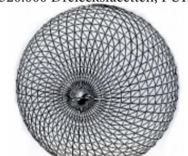
Abb.: STL Modell Kugel 2300 Dreiecksfacetten; PUK
