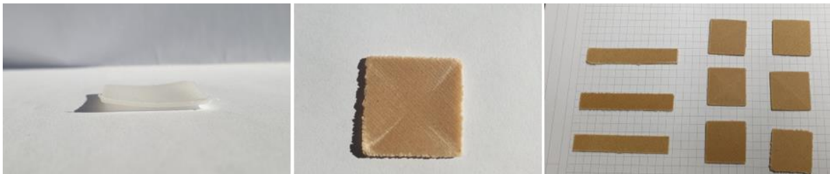
Abbildung 16: Beispiele der ausgestanzten Proben - verformte quadratische Probe (links), weiße Flächen durch elastische/plastische Verformung (mittig), ausgestanzte Proben mit z. T. unsauberen Kanten (rechts)
