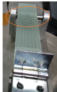
(b) Auflagefehler durch Aufleimer
