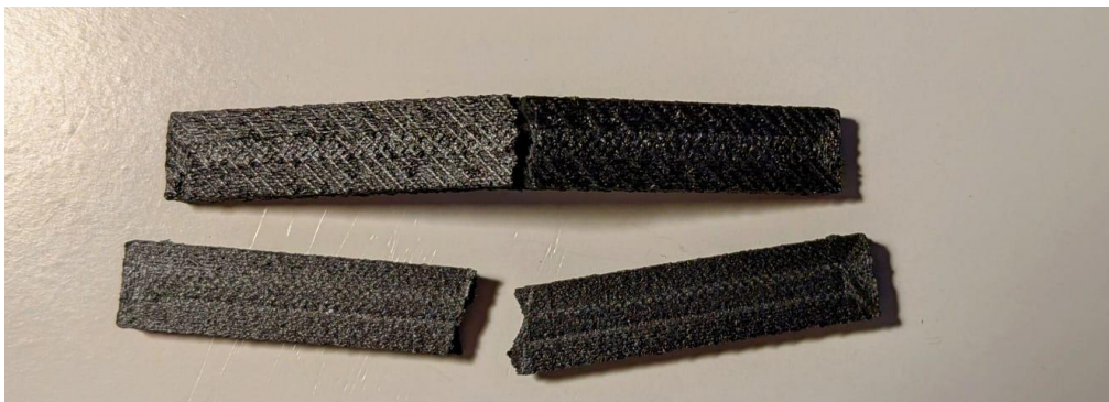
Abbildung 23: Durchbrochener und angebrochener Biegeprüfling aus PPS CF
