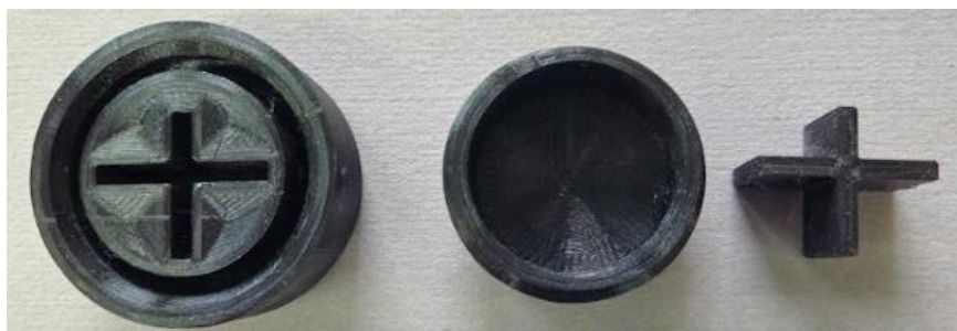
Abbildung 16: Herausgebrochenes Kreuz aus der Positivform
