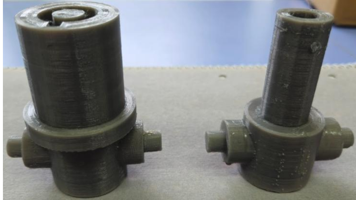
Abbildung 28: Bajonettverschluss mit abgebrochenem Stift
