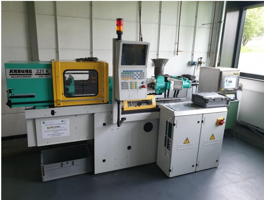
Abbildung 15: Spritzgussmaschine zur Erstellung der Mittelteilproben
