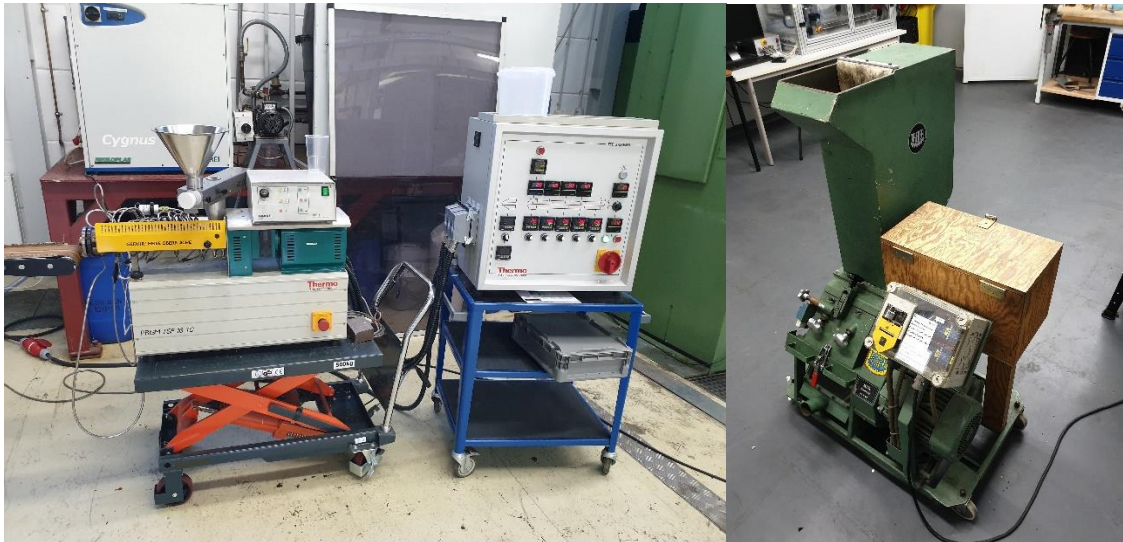
Abbildung 13: Verwendeter Extruder und Granulierer zur Erstellung des Blends
