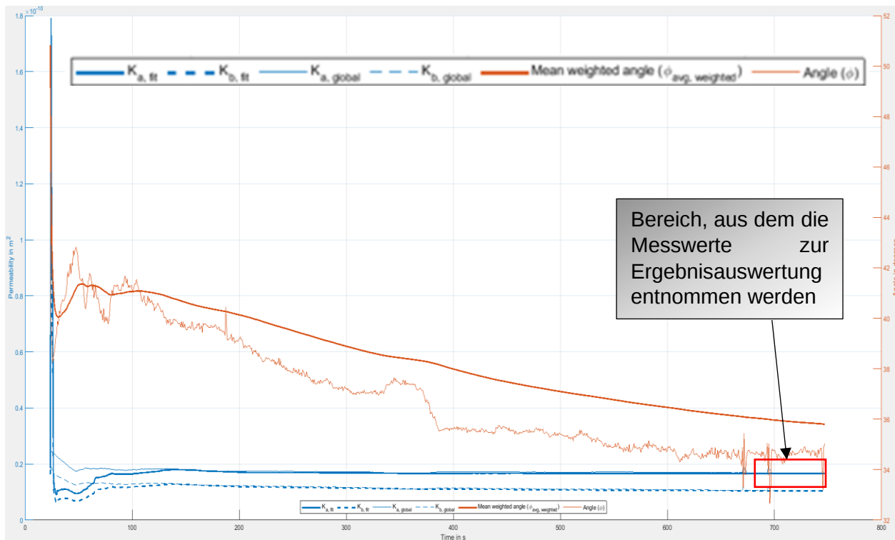
Abbildung 13: Auswertung einer Gewebe-Probe (Screenshot aus dem Computerprogramm), Auftragung der Permeabilität in \text{m}^2 gegen die Zeit in s
