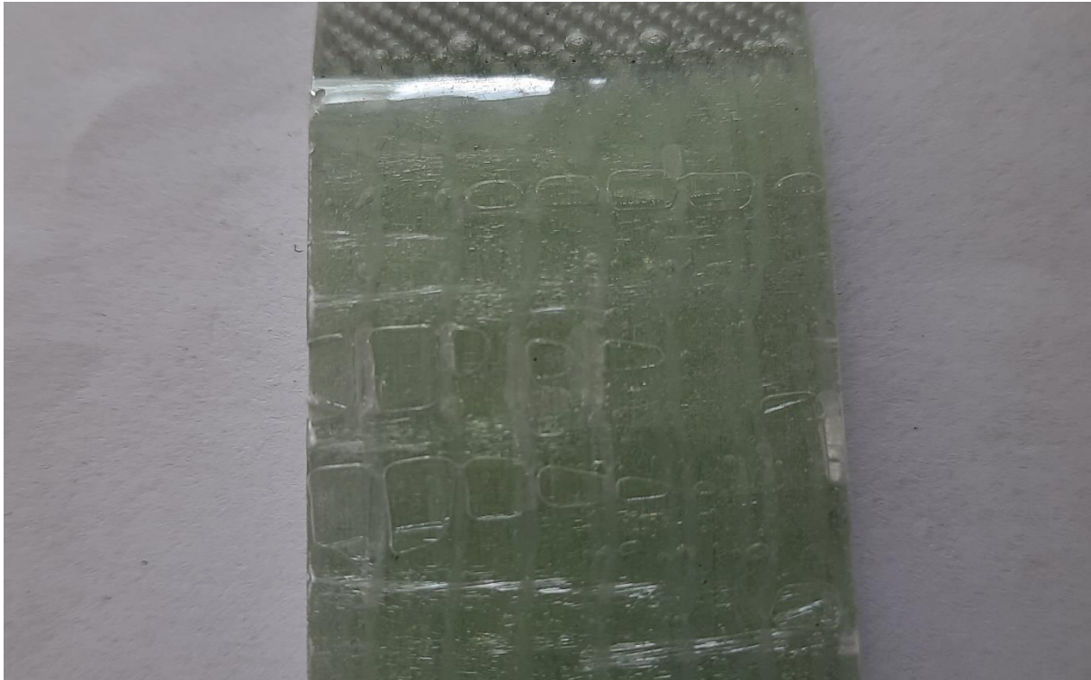
Abbildung 6: Luftblasen an Oberfläche bei Proben Nr. 6.
