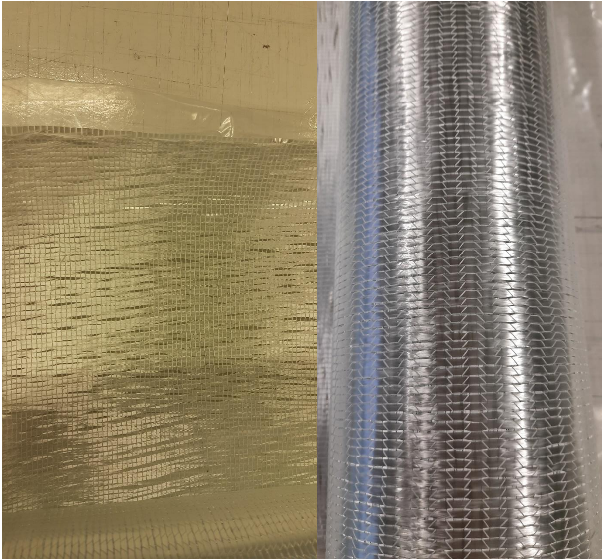
Abbildung 8: schräge „90°“ Glasfaser-Lage (links) und gerade 0^\circ Glasfaser-Lage (rechts).
