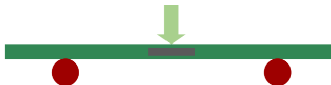
Abbildung 2-3: Schematische Skizze des Prüfaufbaus für Drei-Punkt-Biegeversuch
