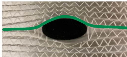
Abbildung 6-1: Konturlinie der Fasern in der Nähe des Dummy-Sensors
