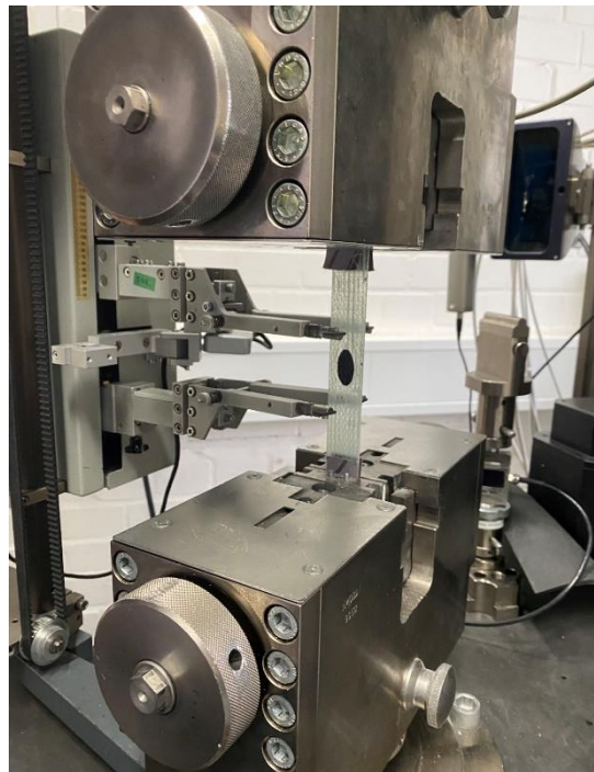
Abbildung 8: Zugversuch für GFK nach DIN ISO 527
