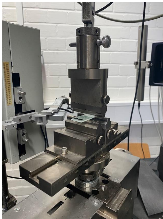
Abbildung 9: Biegeversuch für GFK nach DIN ISO 178
