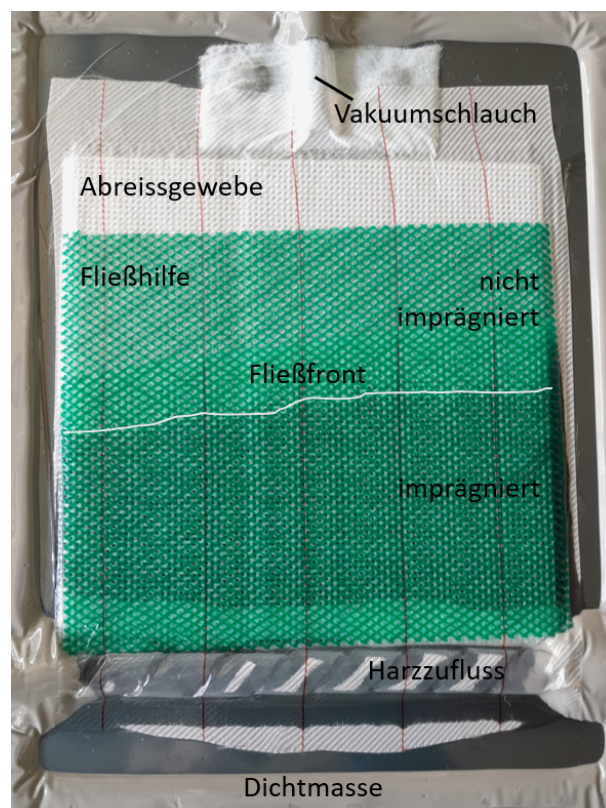
Abbildung 21: Draufsicht auf verwendeten VARI-Aufbau während des Harzflusses
