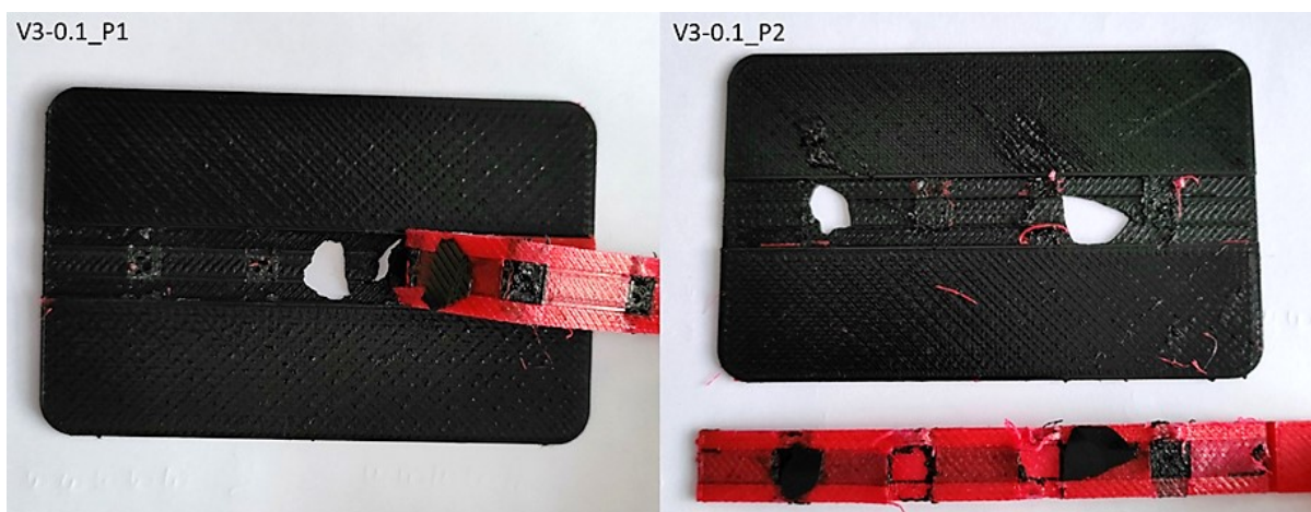
Abb. 4.9 Bruchbild Gitter: Version 3-0,1 mm Schichthöhe.
