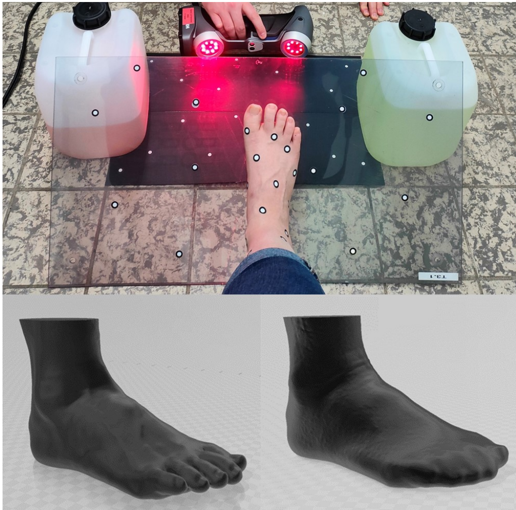
Abb. 3.11 Scanprozess und die daraus resultierten 3D-Modelle.
