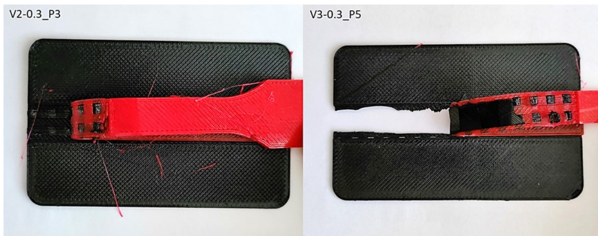
Abb. 4.12 Bruchbild Gitter: Version 2-0,3 mm Schichthöhe.
