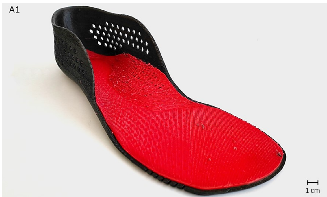
Abb. 4.14 Mittels FLM gefertigte Orthese A. Schichthöhe: 0,3 mm. Rot: TPU; Schwarz: PETG.
