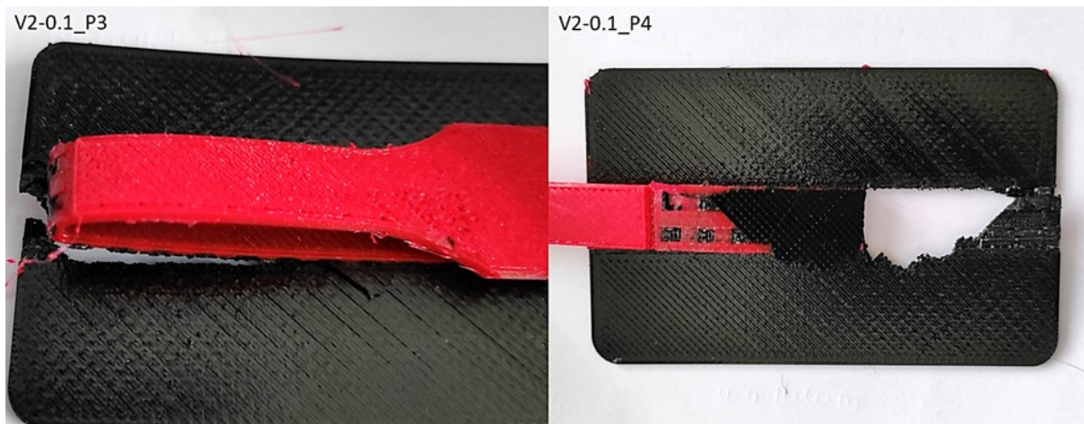
Abb. 4.8 Bruchbild Gitter: Version 2-0,1 mm Schichthöhe.
