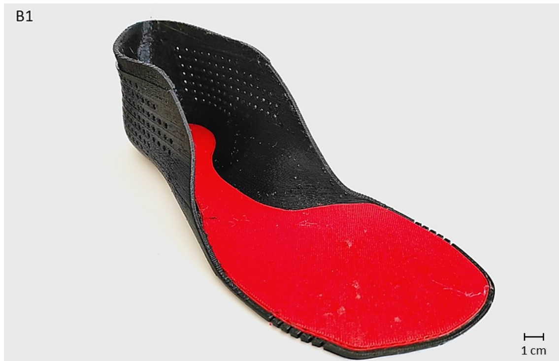
Abb. 4.16 Mittels FLM gefertigte Orthese B. Schichthöhe: 0,3 mm. Rot: TPU; Schwarz: PETG.
