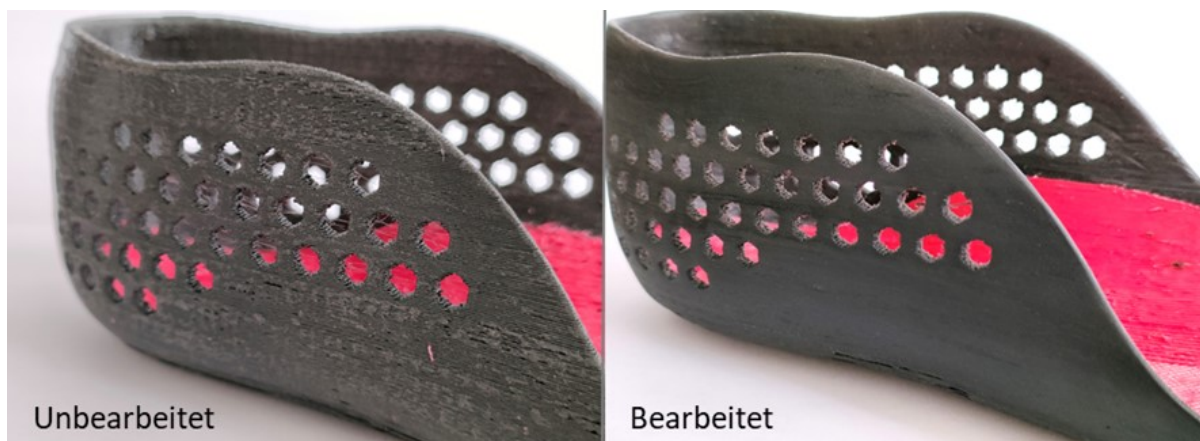
Abb. 4.20 Orthese D unbearbeitet und nachbearbeitet durch Schleifen mit Sandpapier.
