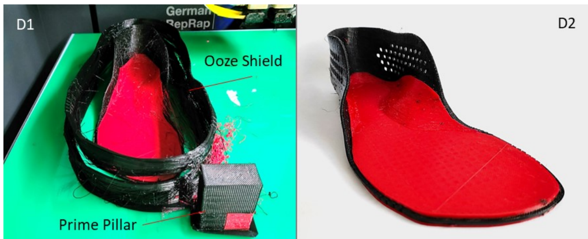
Abb. 4.19 Orthese Version D im Fertigungsprozess und fertige Struktur.
