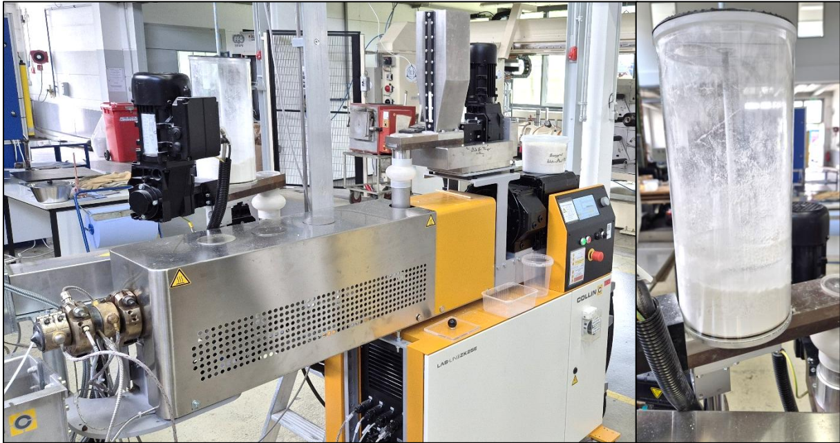
Abbildung 10: Verwendeter COLLIN-Extruder im Betrieb (links), Angepasster Einzugszylinder der Seitendosierung mit eingebautem Rührmechanismus (rechts)
