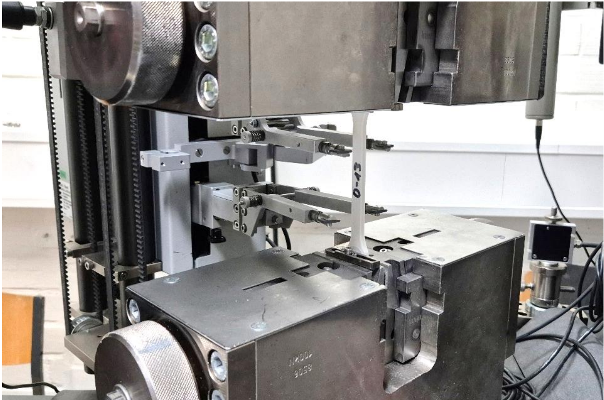
Abbildung 20: Prüfkörper und Extensometer vor Beginn des Zugversuches
