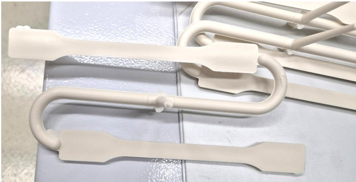
Abbildung 17: Mittels Spritzguss angefertigtes Formteil, welches zwei Schulterprobekörper beinhaltet
