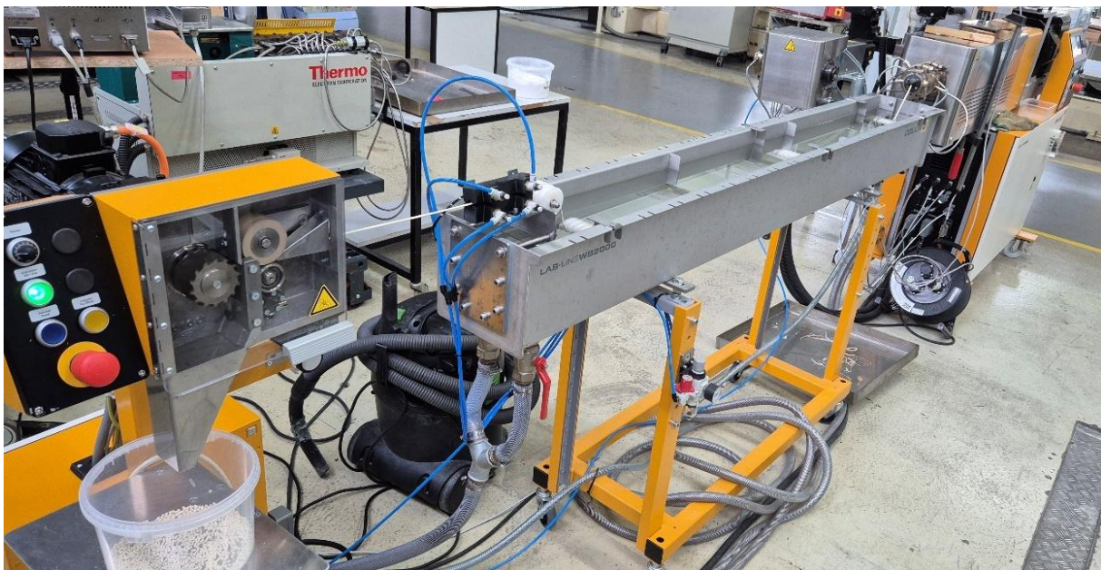
Abbildung 11: Wasserbad und Stranggranulator des Extrusionsprozesses
