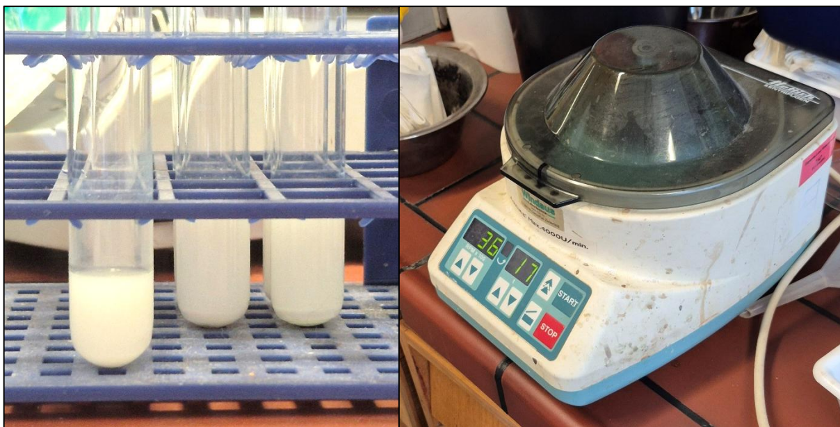
Abbildung 47: Lösung in Dichlormethan (links) und zur Faserseparation verwendete Zentrifuge (rechts)
