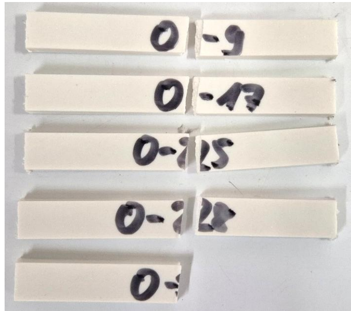
Abbildung 26: Bruchverhalten der Zyklus-0-Proben nach Biegebelastung
