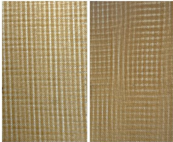
Abbildung 30: Gegen das Licht gehaltene FKV-Platte der Referenz (links) und der mit 48 bar kompaktierten Konfiguration (rechts) des Körpergewebes mit Poren
