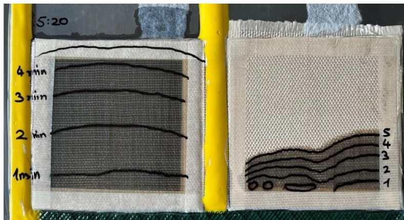
Abbildung 21: Vergleich der Fließfronten im VARI-Verfahren von unkompaktierten (links) und kompaktierten (rechts) Lagenaufbauten am Beispiel des Leinwandgewebes
