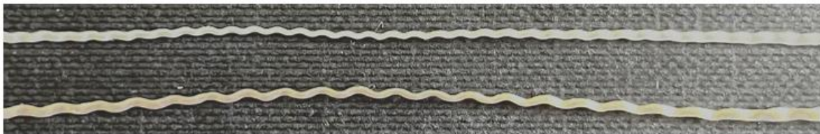
Abbildung 38: Welligkeit der ungeprüften Garne aus Schussrichtung (oben) und aus Kettrichtung (unten)
