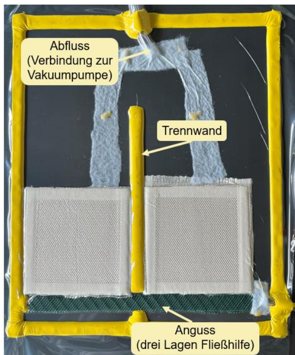
Abbildung 20: VARI-Aufbau für die Vorversuche am Beispiel des Leinwandgewebes
