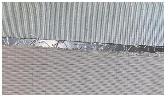
Abbildung 47: Leinwandgewebe vor Lagerung (oben) und nach der Lagerung (unten) im Ofen bei 105 °C
