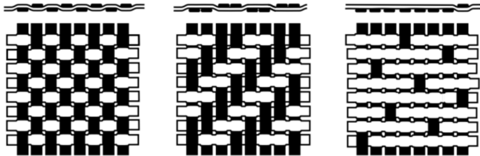
Abbildung 7: Grundbindungen von Geweben (links: Leinwand-, Mitte: Köper-, rechts: Atlasbindung) [Ehr06]
