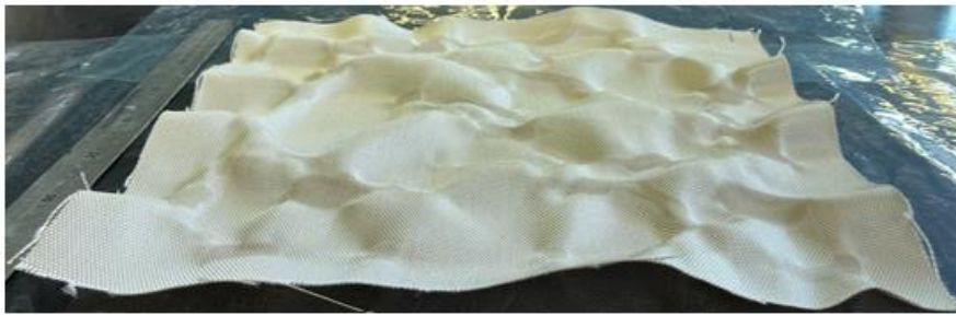
Abbildung 46: Schrumpfverhalten des Leinwandgewebes bei Wasserkontakt
