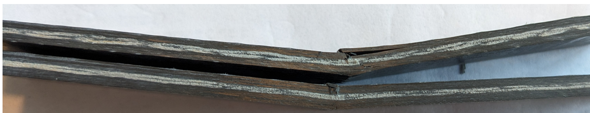
Abbildung 5.26: Probenvergleich: unten vorkompaktiert, oben unkomapktiert
