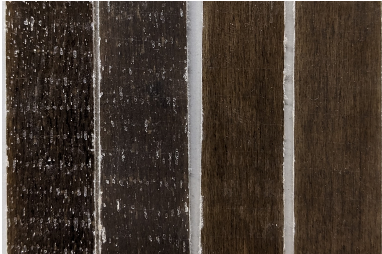
Abbildung 5.3: Naturfaserlamine links mit und rechts ohne Luftblasen
