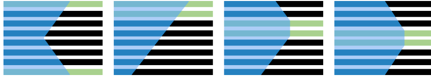
Abbildung 6.1: Fließfronten der unterschiedlichen Laminataufbauten
